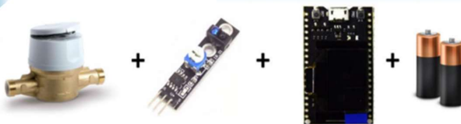
Componentes del nuevo módulo de comunicación para contadores mecánicos de agua doméstica ideado por el grupo Simply 5.
