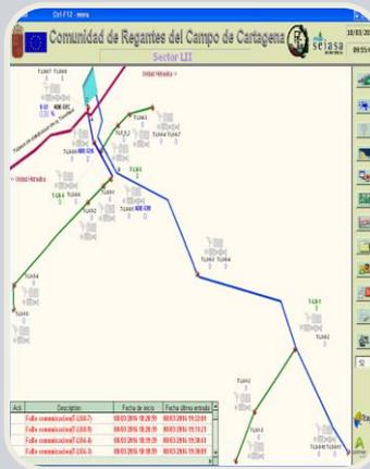
Sistemas de supervisión y adquisición de datos (SCADA)
